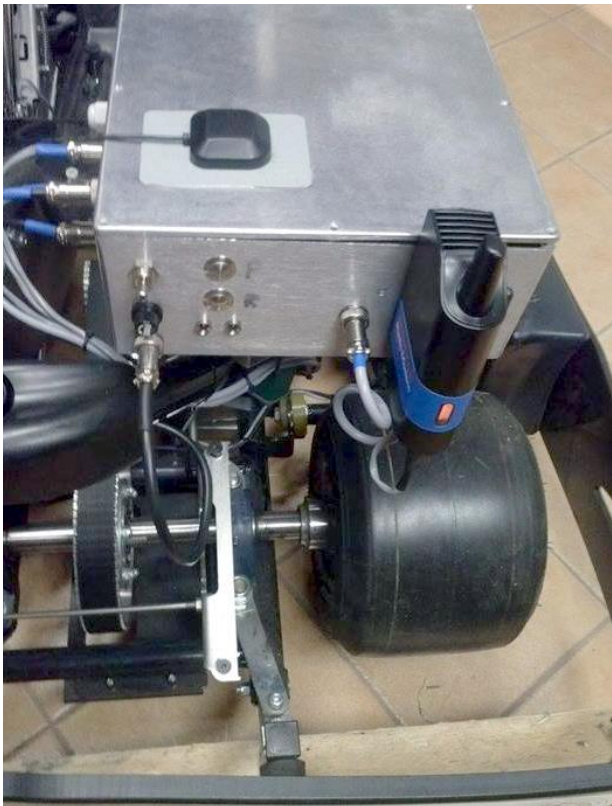
Rys. 2.13. Montaż obudowy na tylnej ramie gokarta
