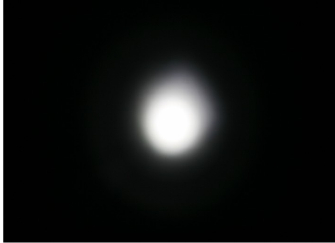
Rys. 8. Plama świetlna uzyskana dla soczewki LXP RS 10661
