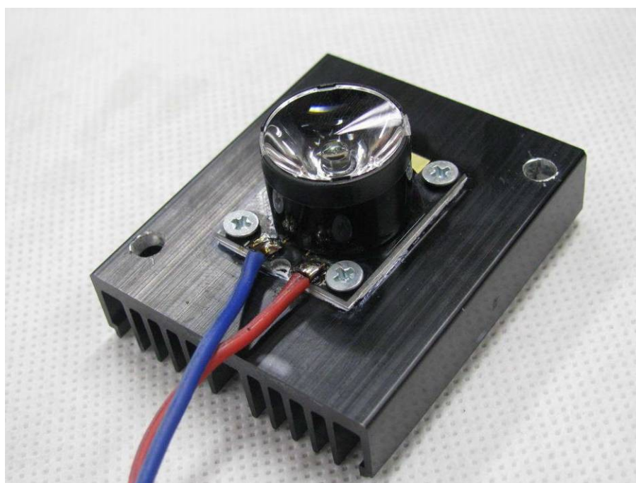
Rys.10. Dioda LED Cree XPG wraz z soczewką LXP-RS-10661 Real Spot
