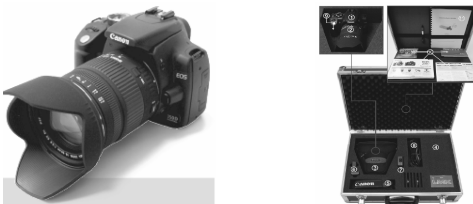
Rys.1. Kamera CCD firmy LMK do pomiaru luminancji wraz z niezbędnym wyposażeniem [4]
