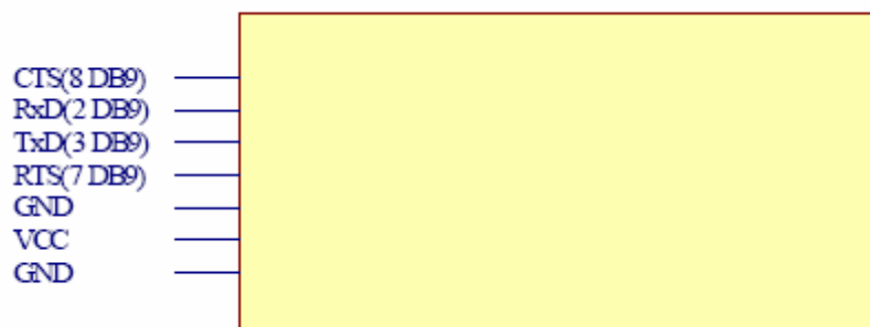
Opis złącza gold pin radiomodemu - RS232
