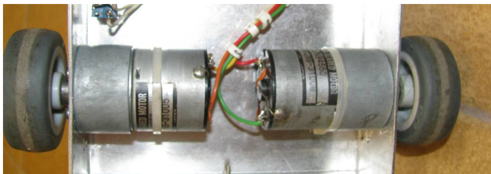
Zastosowane silniki Sayama 24V, 240 obr/min z przekładnią
