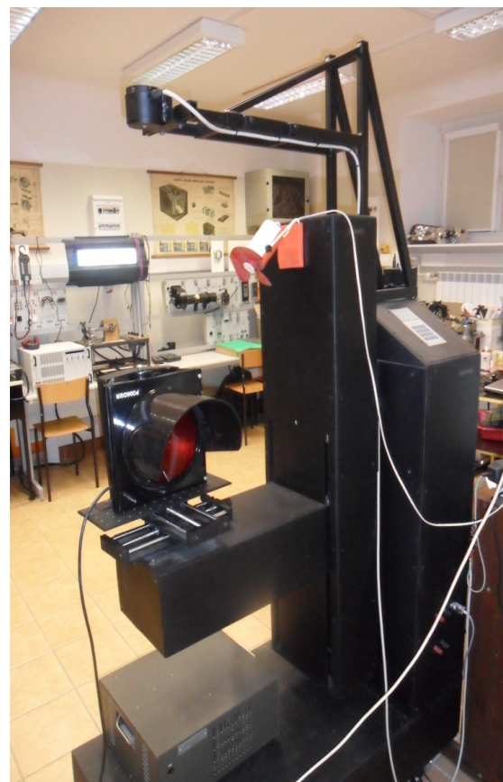
Rys. 1 Pomiar światłości wybranego typu sygnalizatora za pomocą goniometru BIG 128
