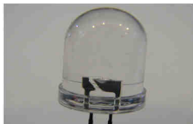
Struktura wewnętrzna diody elektroluminescencyjnej: anoda (+) po lewej, katoda (-) po prawej stronie
