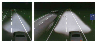
inteligentny system oświetlenia
