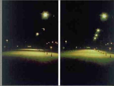
Rys. 3 Dwie sytuacje o różnej równomierności luminancji drogi. Po prawej stronie ze względu na wysoką jej równomierność widać przeszkodę w postaci kostki położonej na drodze. Po lewej stronie kostka ta jest w strefie ciemnej i przez to jej nie widać.
