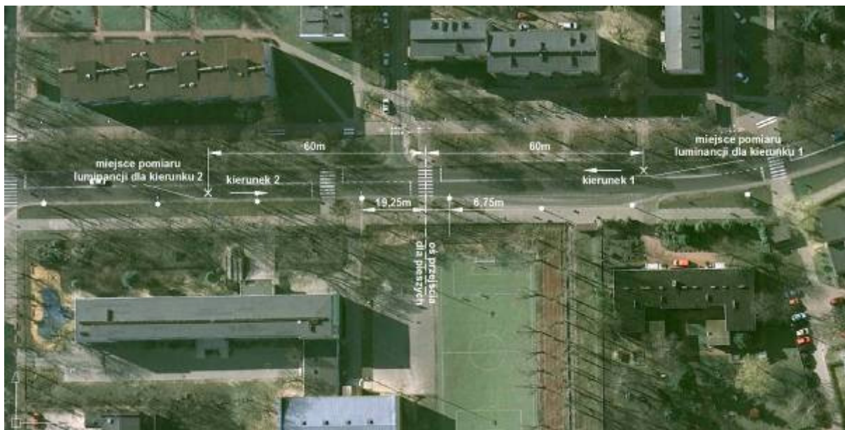
Rys. 3. Usytuowanie oświetlenia ulicznego względem przejścia dla pieszych
