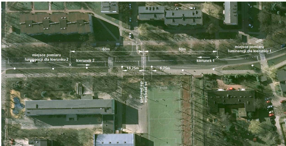
Rys. 10. Usytuowanie oświetlenia ulicznego względem przejścia dla pieszych
