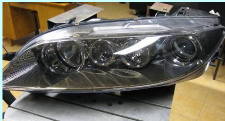
Reflektor elipsoidalny z lampą wyładowczą firmy Automotive Lighting
