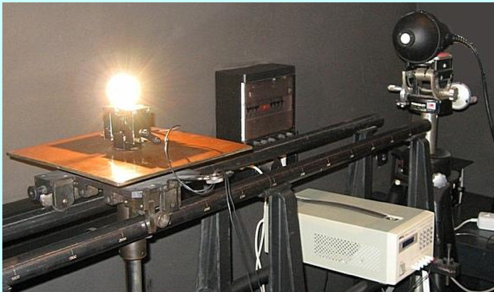
Pomiar barwy i temperatury barwowej za pomocą kolorymetru SC 2000
