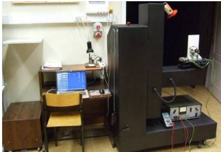
Goniometr BIG 128 wraz z komputerem sterującym oraz Fotometr DIGI-02
