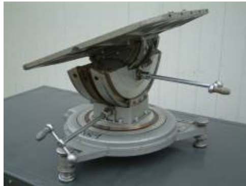
Goniometr sterowany ręcznie oraz fotometr Lutron Lx 105
