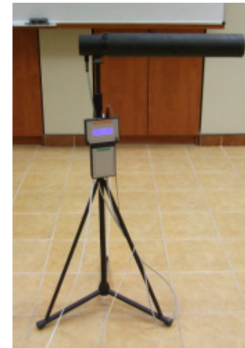
Goniometr BIG 128 wraz z komputerem sterującym oraz Fotometr DIGI-02
