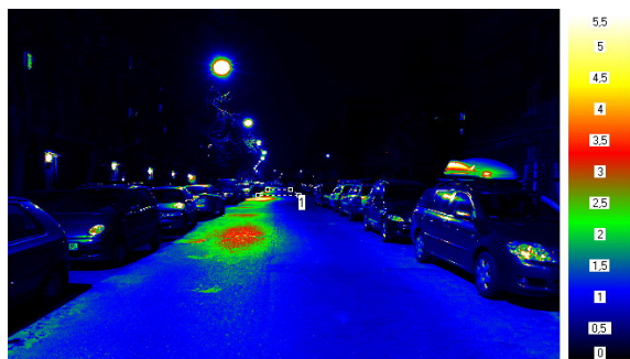
Rys.9. Uzyskany rozkład luminancji [\text{cd/m}^2] na odcinku 1 (Advision)
