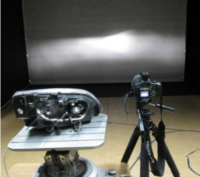
Rys. 4.2. Stanowisko do pomiaru luminancji
