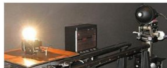
Rys. 2.2. Stanowisko do badań żarówek
