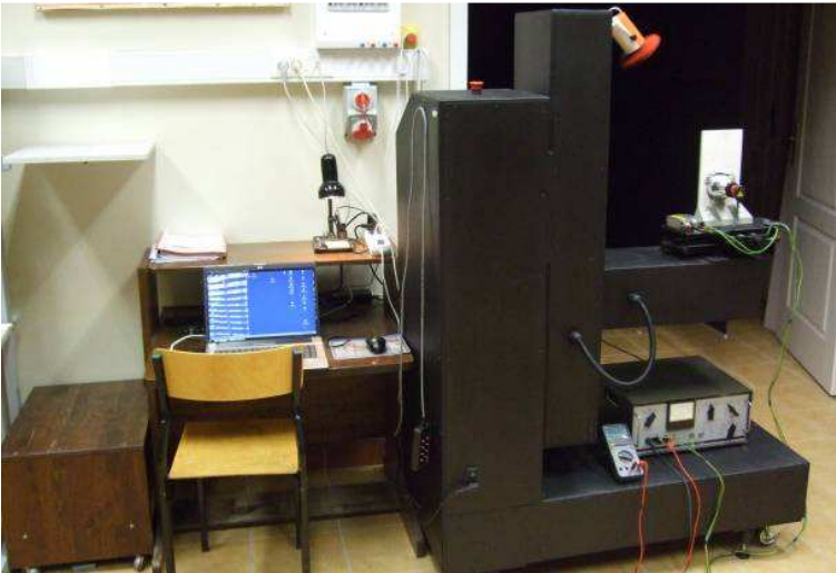
Rys.5. Goniometr BIG128 wraz z komputerem sterującym
